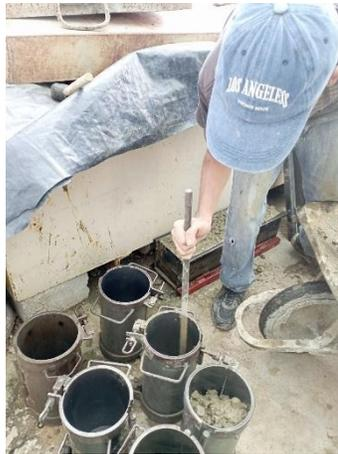
Nota: Concreto en 3 capas en las probetas cilíndricas, aplicando 24 golpes en toda su superficie. Tomada en PREGO por Battaglini, F. & Gonzalez A. (2024).
