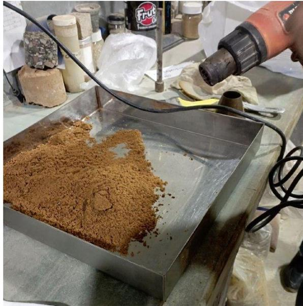
Nota: Secado con pistola de calor para la determinación de la condición de humedad saturada superficie seca. Tomada en PREGO por Battaglini, F. & Gonzalez A. (2024). [Fotografía]
