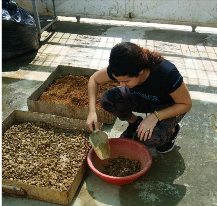
Nota: Obteniendo la cantidad de muestra de la piedra para determinar su peso específico y absorción. Tomada en PREGO por Battaglini, F. & Gonzalez A. (2024). [Fotografía]
