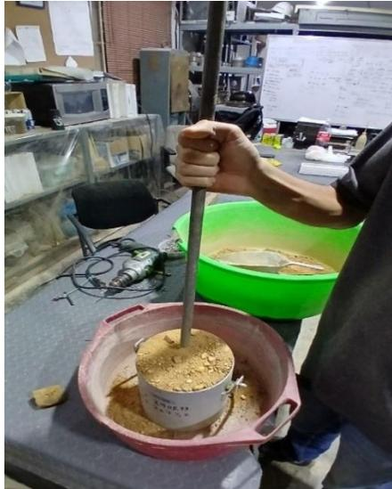
Nota: Compactación de la arena para evitar aires en el ensayo de peso unitario compactado. Tomada en PREGO por Battaglini, F. & Gonzalez A. (2024). [Fotografía]
