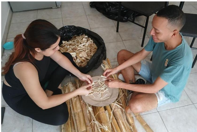
Nota: Desglosando el bagazo para ser usado en la mezcla experimental. Tomado por Battaglini, F. & Gonzalez A. (2024). [Fotografía]
