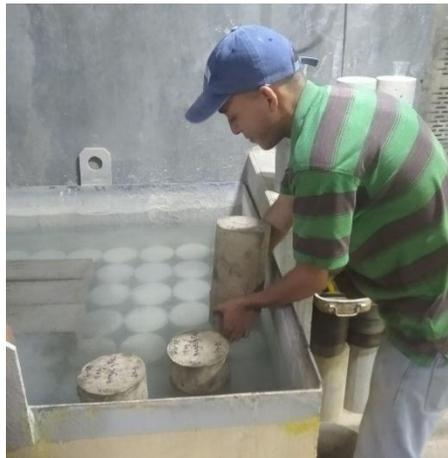
Nota: Viguetas y cilindros en el tanque con cal para su curado. Tomada en PREGOR por Battaglini, F. & Gonzalez A. (2024). [Fotografía]
