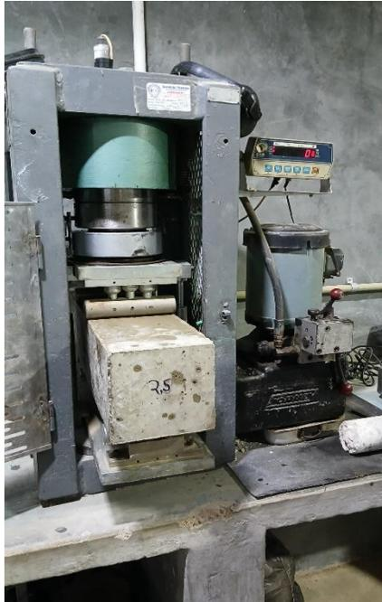
Nota: Vigueta colocada en la máquina para determinar su resistencia. Tomada en PREGO por Battaglini, F. & Gonzalez A. (2024). [Fotografía]
