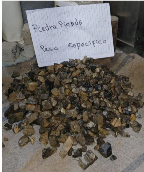
Nota: Secado de la piedra picada para la determinación de la condición de humedad S.S.S. Tomada en PREGO por Battaglini, F. & Gonzalez A. (2024). [Fotografía]
