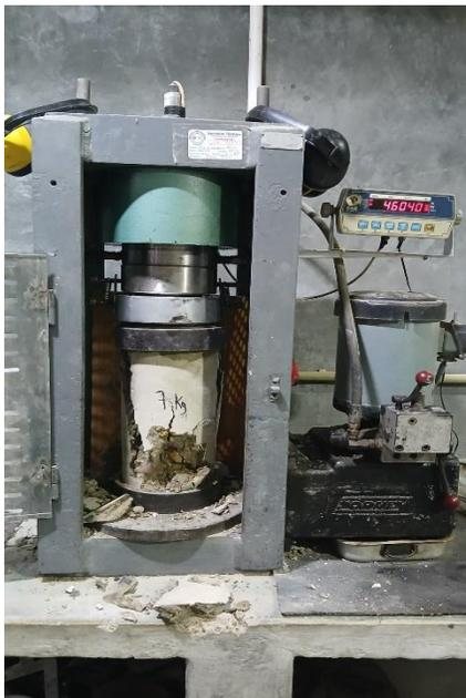
Nota: Cilindro ensayado ya con la resistencia determinada. Tomada en PREGO por Battaglini, F. & Gonzalez A. (2024). [Fotografía]
