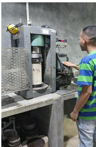
Nota: Cilindro colocado en la máquina de ensayo a compresión. Tomada en PREGO por Battaglini, F. & Gonzalez A. (2024). [Fotografía]
