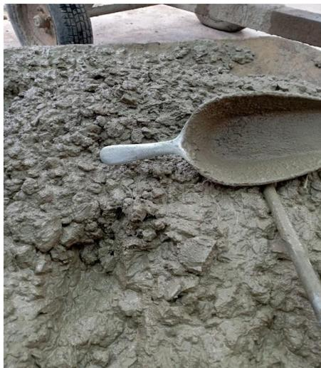
Nota: Estado de la muestra del concreto con aditivo de fibra de bagazo. Tomada en PREGO por Battaglini, F. & Gonzalez A. (2024). [Fotografía]
