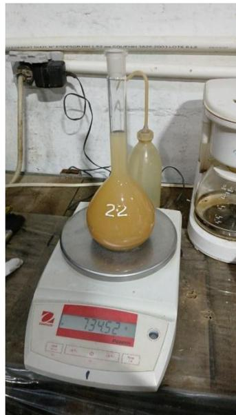
Nota: Determinación del peso del picnómetro con la muestra SSS y agua. Tomada en PREGO por Battaglini, F. & Gonzalez A. (2024). [Fotografía]
