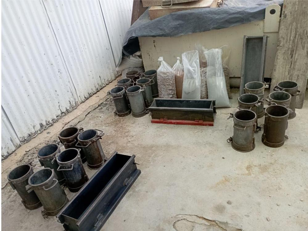
Nota: Materiales, probetas cilíndricas y probetas prismáticas listos para el vertido del concreto. Tomada en PREGO por Battaglini, F. & Gonzalez A. (2024). [Fotografía]
