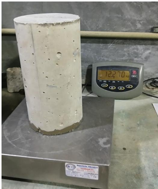
Nota: Peso del cilindro en balanza equilibrada. Tomada en PREGO por Battaglini, F. & Gonzalez A. (2024). [Fotografía]
