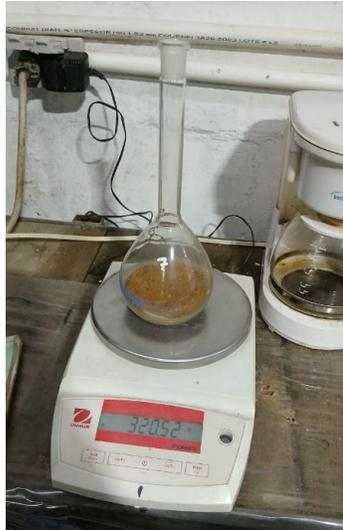
Nota: Muestra S.S.S en el picnómetro para su pesado en balanza. Tomada en PREGO por Battaglini, F. & Gonzalez A. (2024). [Fotografía]
