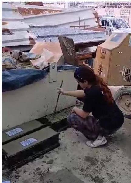
Nota: Concreto en probetas prismáticas en 2 capas, aplicando 60 golpes en toda su superficie. Tomada en PREGO por Battaglini, F. & Gonzalez A. (2024).
