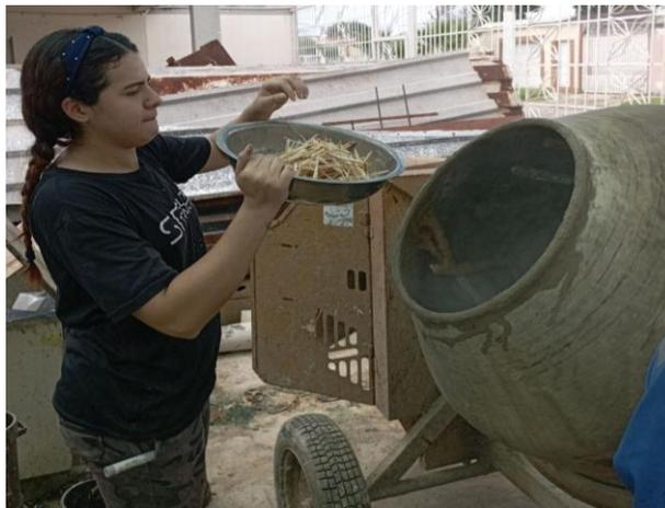
Nota: Agregando las fibras del bagazo al concreto para obtener el concreto experimental. Tomada en PREGO por Battaglini, F. & Gonzalez A. (2024). [Fotografía]
