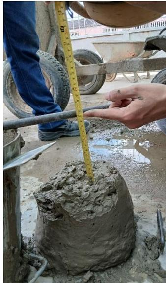
Nota: Resultado del asentamiento del concreto con adición 2,5 kg/m<sup>3</sup>. Tomada en PREGO por Battaglini, F. & Gonzalez A. (2024). [Fotografía]
