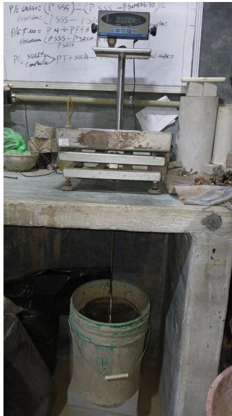
Nota: Muestra de piedra picada sumergida en agua en balanza para determinar su peso. Tomada en PREGO por Battaglini, F. & Gonzalez A. (2024). [Fotografía]
