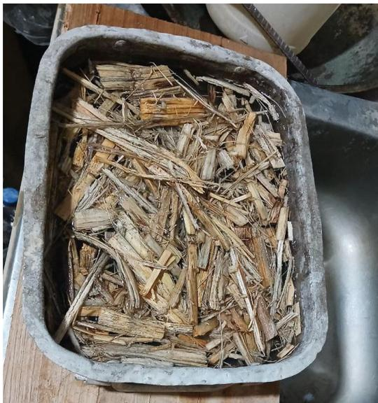
Nota: Bagazo ya cortado sumergido en agua por 24 horas. Tomada en PREGO por Battaglini, F. & Gonzalez A. (2024). [Fotografía]
