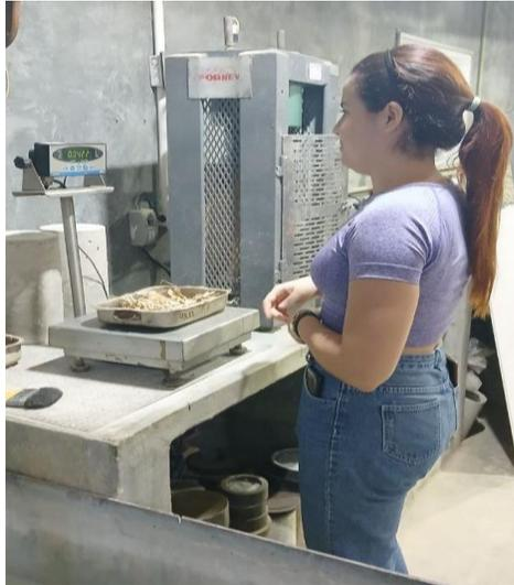
Nota: Peso de la muestra del bagazo en balanza equilibrada para determinar el porcentaje de absorción. Tomada en PREGO por Battaglini, F. & Gonzalez A. (2024). [Fotografía]
