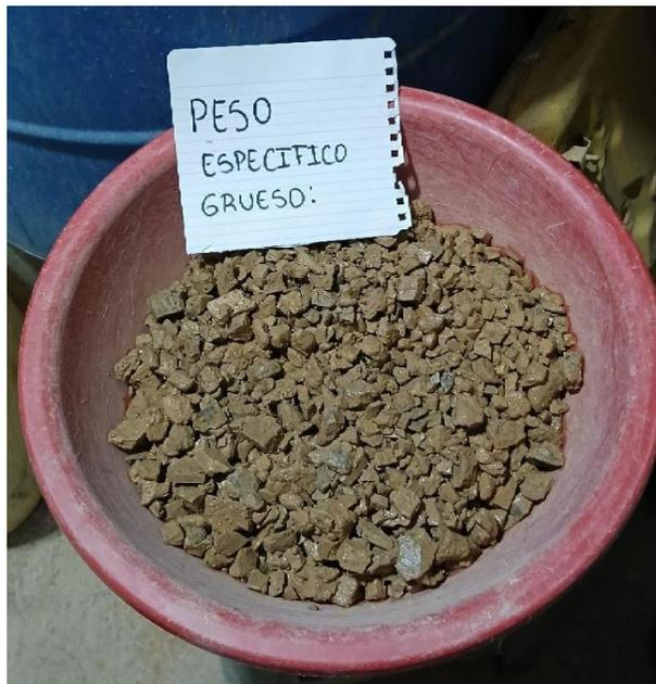
Nota: Se colocó la muestra en un recipiente para ser sumergida en agua.
