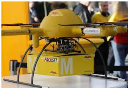
**Figura 4.2. Dron DHL para el envío de paquetes**
