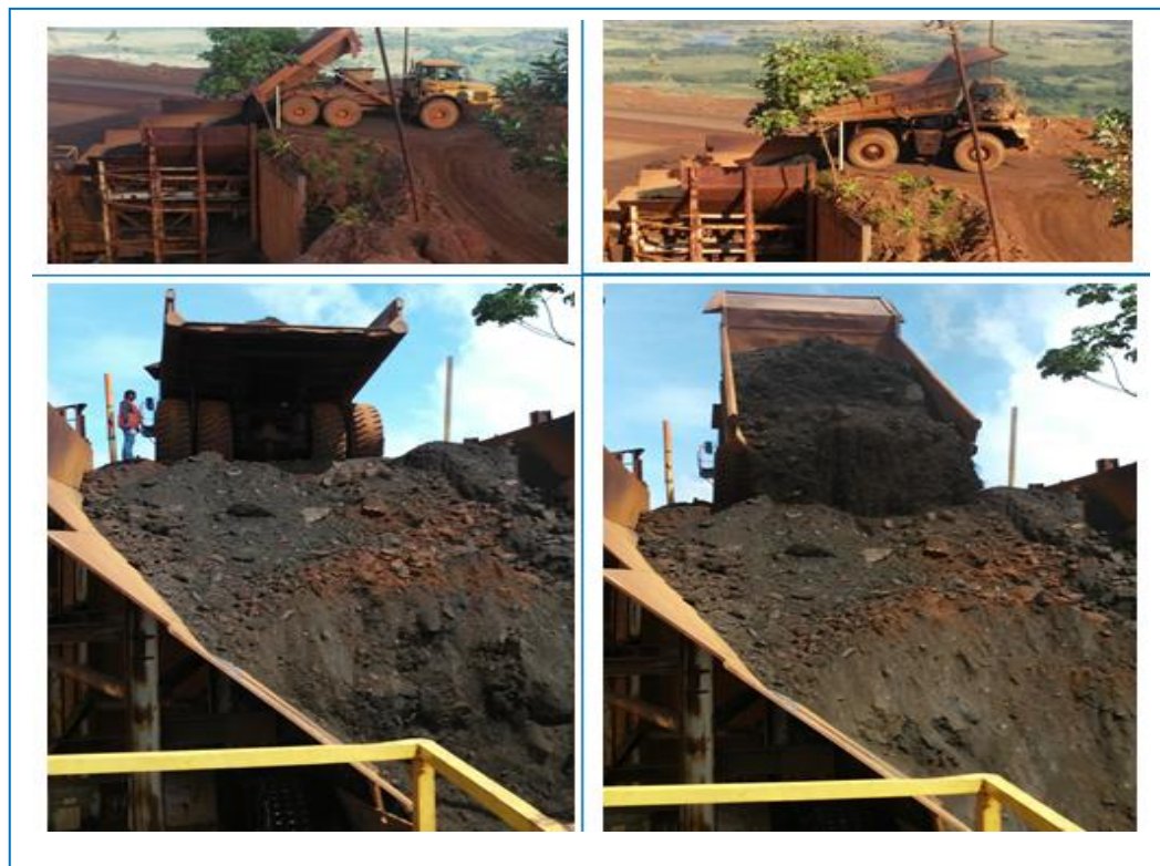
Figura 4.6 Descarga del Mineral a la Planta de trituración
