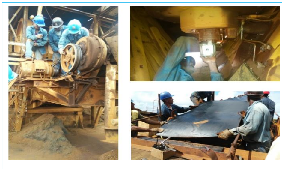
Figura 4.39 Cambio de correas, cita transportadora, bomba molino (Centeno, 2017)
