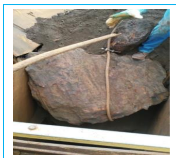
Figura 4.6 Roca de sobre tamaño en molino primario (Centeno, 2017)
