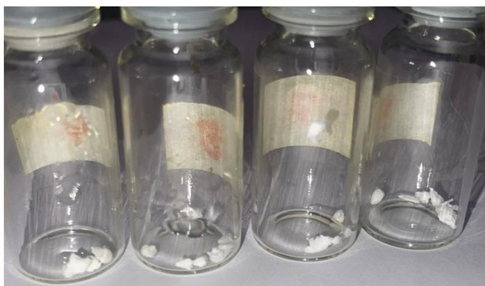
Figura 21. Muestras de MP de ePS pesadas y clasificadas en viales de vidrio
