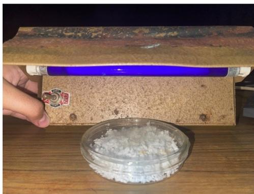
Figura 17. Lámpara UV-B empleada para fotooxidar muestras de ePS.
