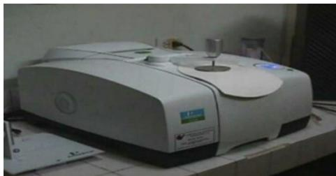
Figura 18. Espectrómetro FTIR empleado para la caracterización de los MP
