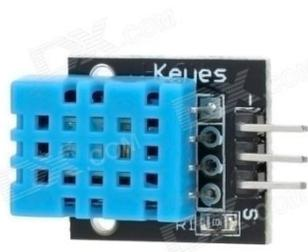
Figura 17. Sensor de temperatura DHT11
