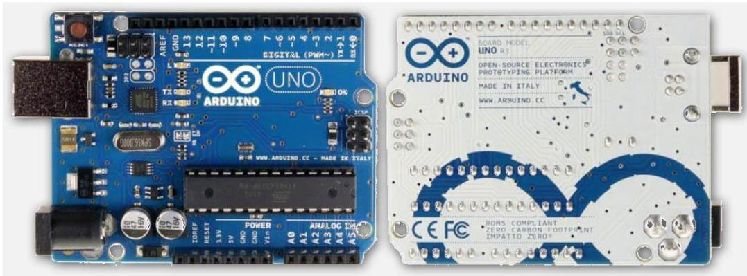
Figura 15. Arduino Uno, vista superior e inferior
