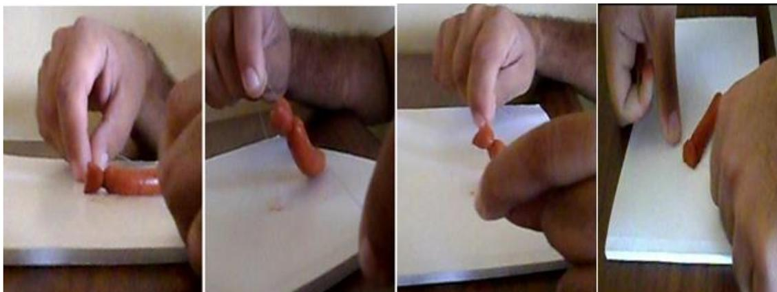
**Figura 76.** Fotografías del hidrogel híbrido de poliacrilamida/lodo rojo (PL10SAE) mostrando resistencia al corte por nylon.
