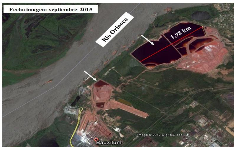
**Figura 9.** Lagunas de lodo rojo producido en CVG-BAUXILUM, ubicadas en el estado Bolívar-Venezuela.
