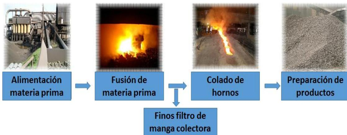
**Figura 11.** Esquema del proceso productivo de HEVENSA (<http://www.hevensa.com/>).
