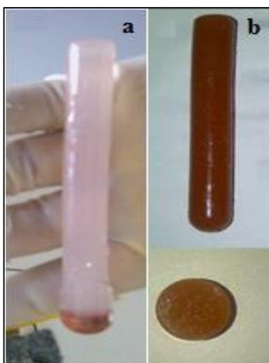
**Figura 29.** Fotografías de hidrogeles híbridos posterior a la síntesis: a) poli(acrilamida-co-ácido itacónico)/LR; b) poliacrilamida/LR.
