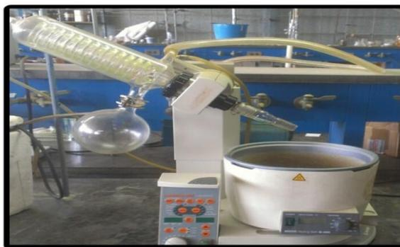
Figura 2. Rotaevaporador marca Büchi 461
