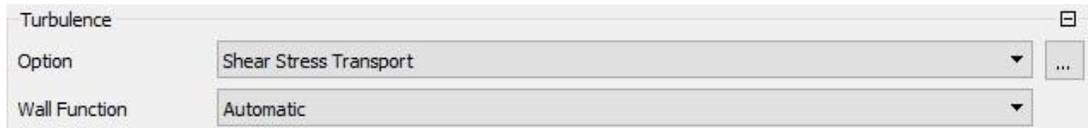
**Figura 5.18.** Interfaz para la selección del modelo de turbulencia  $k-\omega$  SST en CFX.
