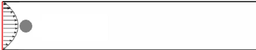
**Figura 3.2.** Representación del perfil de velocidad del flujo a la entrada del canal.
