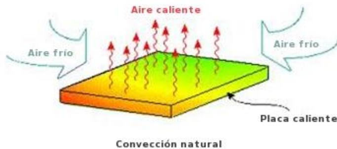
**Figura 2.1.** Transferencia de calor por convección natural [9].
