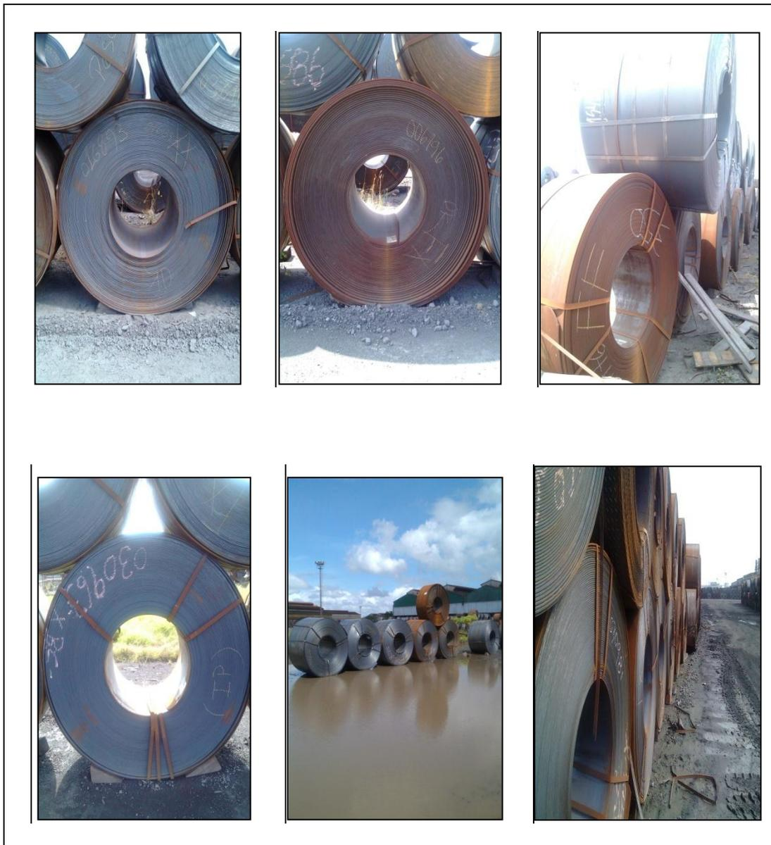
Figura G.8. Bandas y bobinas en malas condiciones
