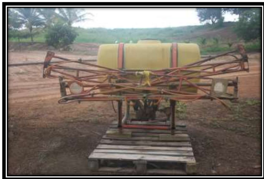
Figura 9. Asperjadora hidráulica AVCA de 600 litros, productor Eulises Salazar.
