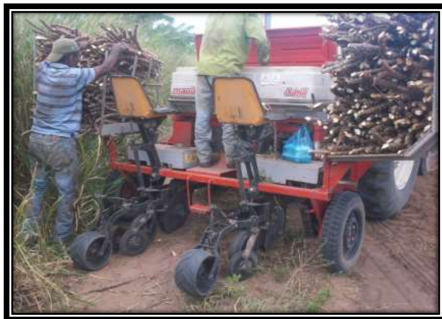
Figura 13. Sembradora de yuca Jumil de 2 hilos, productor Arístides Canelón.
