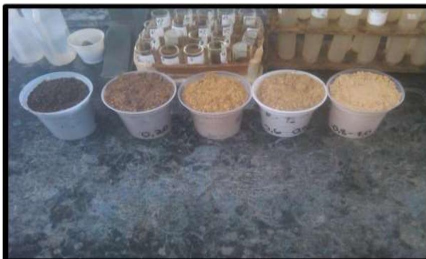
**Figura 4 Muestras a distintas profundidades del suelo**
