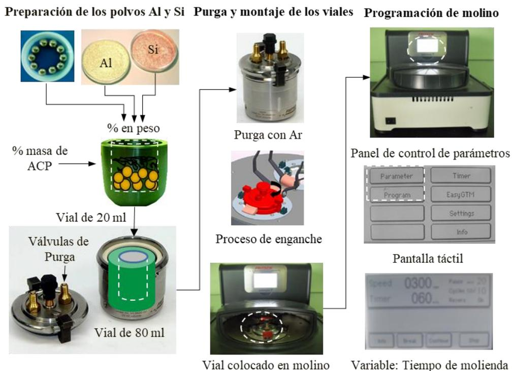
Figura 2.4. Fases de la fabricación de las muestras M1 y M2 usando el molino Planetario PULVERISETTE 7 (GFM – UDO).
