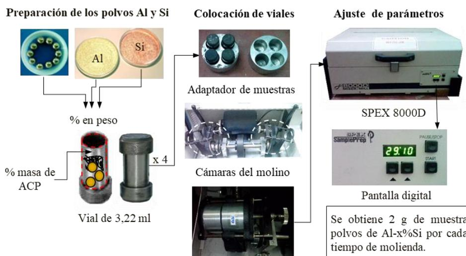
Figura 2.5. Fases de la fabricación de las muestras Al-10, 30, 50 y 70% peso Si usando el molino/mezcladora SPEX 8000D (CIMN – IVIC).
