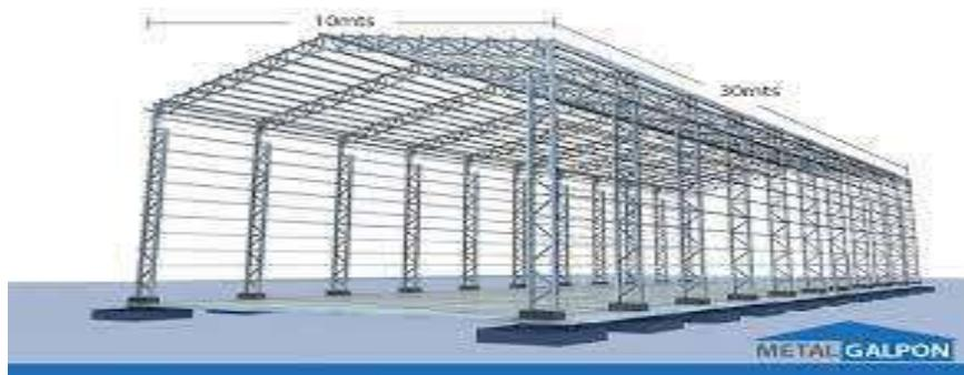
**Figura 3.1 Disposición de cerchas de un galpón. (GLOBAL3.CL, 2021)**
