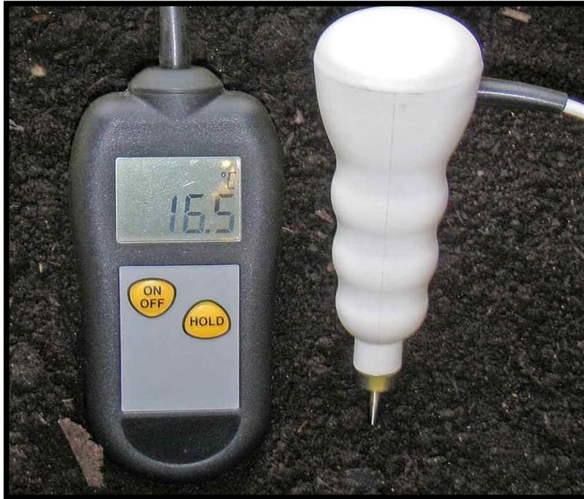
**Figura 5.52.: Monitorización de temperatura del compost (Martin Lishman).**
