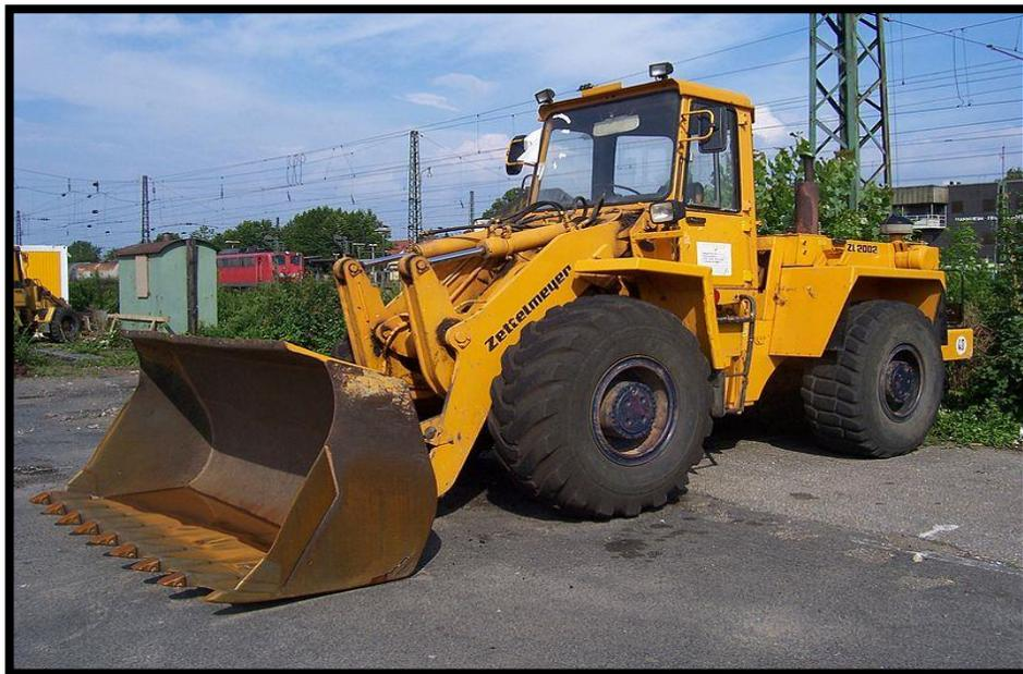
**Figura 5.59.: Cargador frontal sobre neumáticos. (Wikipedia, 2023).**
