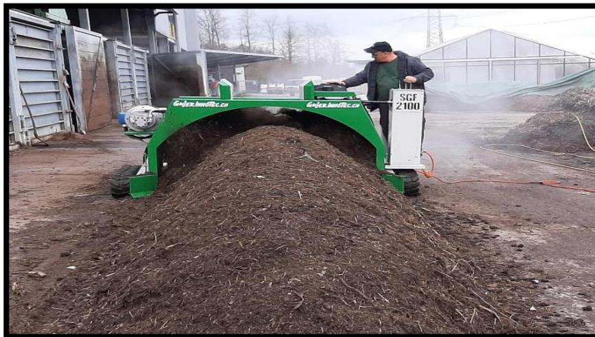
**Figura 5.48.: Funcionamiento de una volteadora de compost. (gujerinnotec, 2023).**
