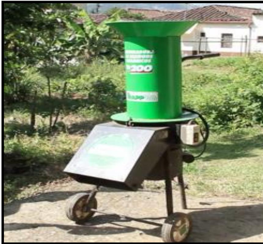
**Figura 5.50.: Triturador de residuos orgánicos para compostaje con motor eléctrico estación de cribadora. (finca y campo, 2023).**
