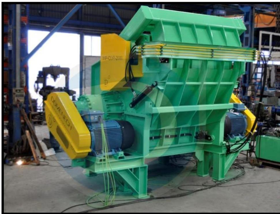
**Figura 5.39.: Molino triturador de desechos sólidos. (domenech, 2015).**
