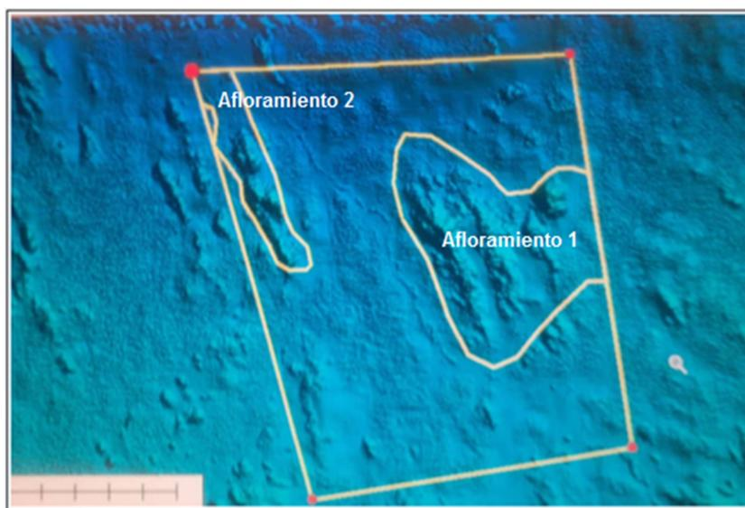
Figura 5.8 Representación esquemática de los 2 afloramientos más importantes del Hato El Novillo para el cálculo del volumen granítico.
