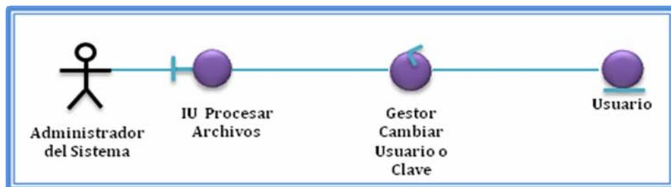
**Figura 5.10. Diagrama de Clase de Análisis Procesar Archivos- Cambiar Usuario, Clave.**
