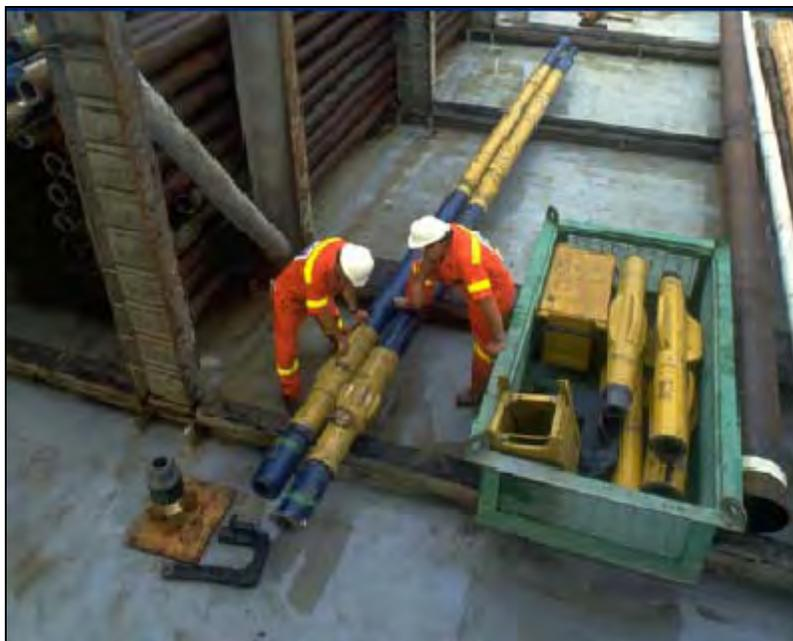
**Figura 2.9. Supervisión de los estabilizadores antes de bajarlos al pozo**
