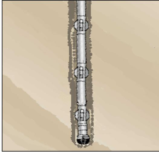
**Figura 2.5. Ensamblaje de fondo para mantener ángulo**
