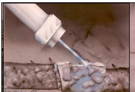
Figura 3.19 Penetración del agua en el hormigón deteriorado.
