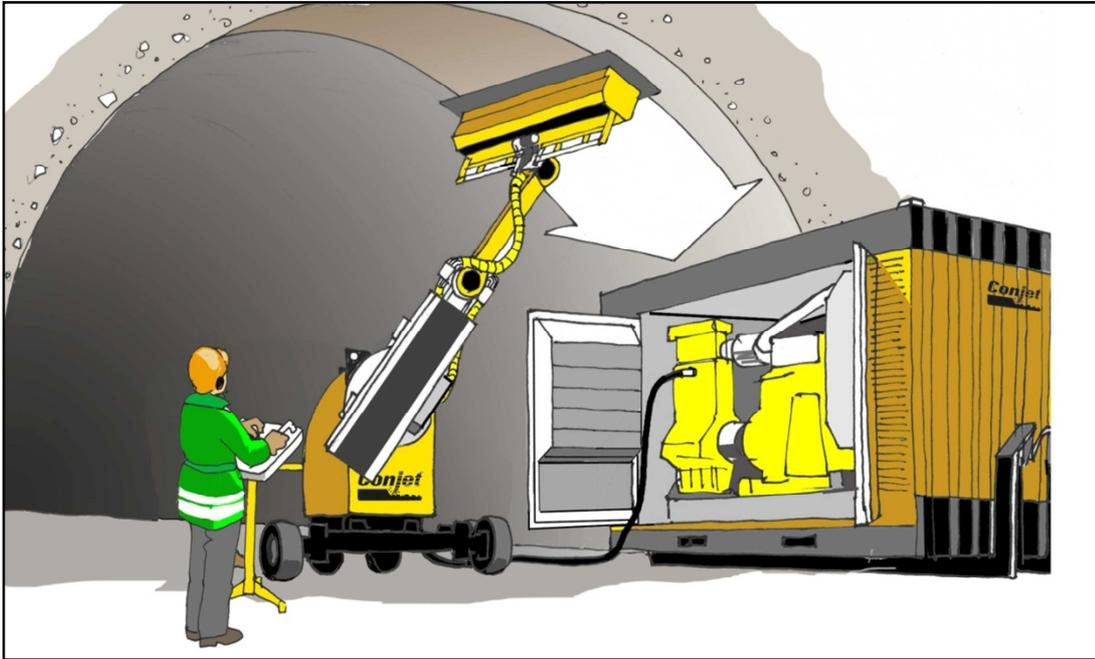
Figura 3.22. Conjunto bomba – robot para hidrodemolición (www.anzeve.com, 2010).
