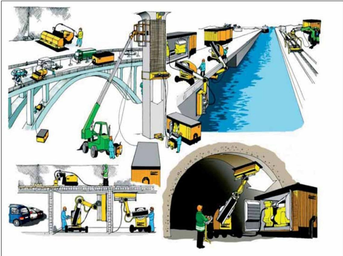
Figura 3.26. Aplicaciones de la hidrodemolición robotizada. (www.anzeve.com, 2010).
