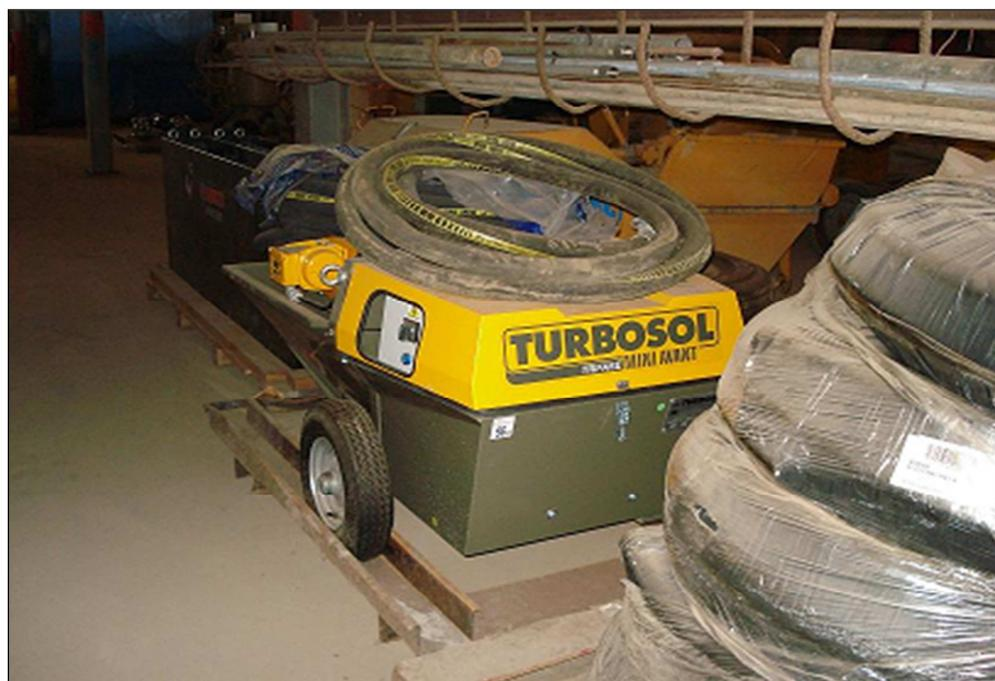
Figura D.3. Equipo para proyectar concreto en el canal 1 del aliviadero.
