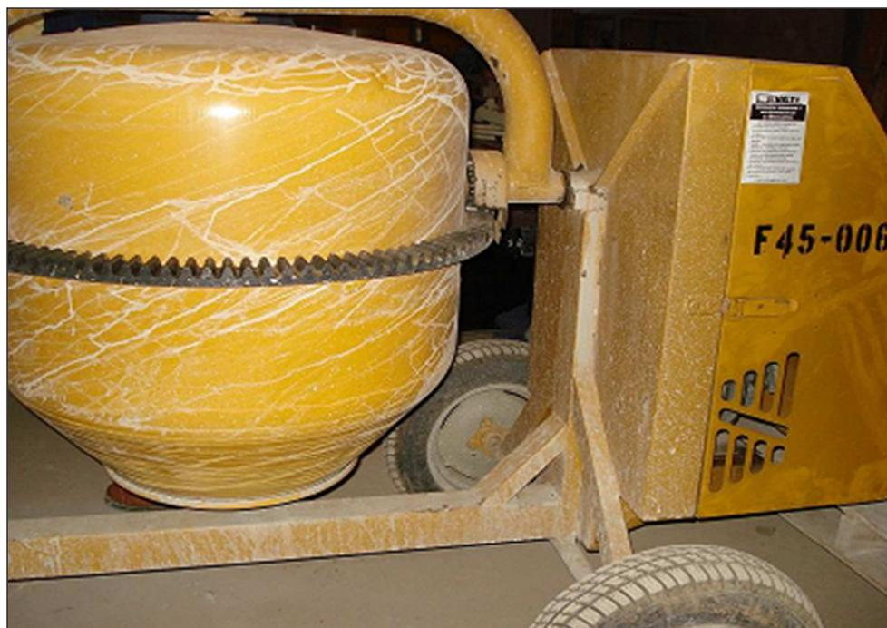
Figura D.2. Trompo para mezcla de concreto y mortero.
