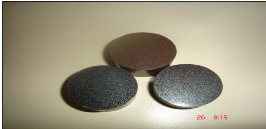
Figura 4.11 Baquelitas una vez terminada de pulir.
