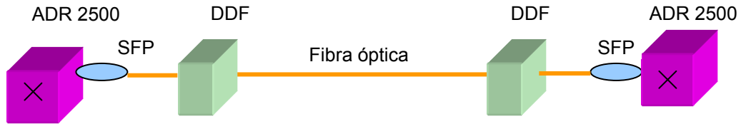
Figura.5.2 Módulo de enlace de fibra óptica. Fuente Propia.
