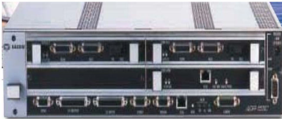
Figura. 4.5. Parte frontal del equipo ADR 155C. [15]
