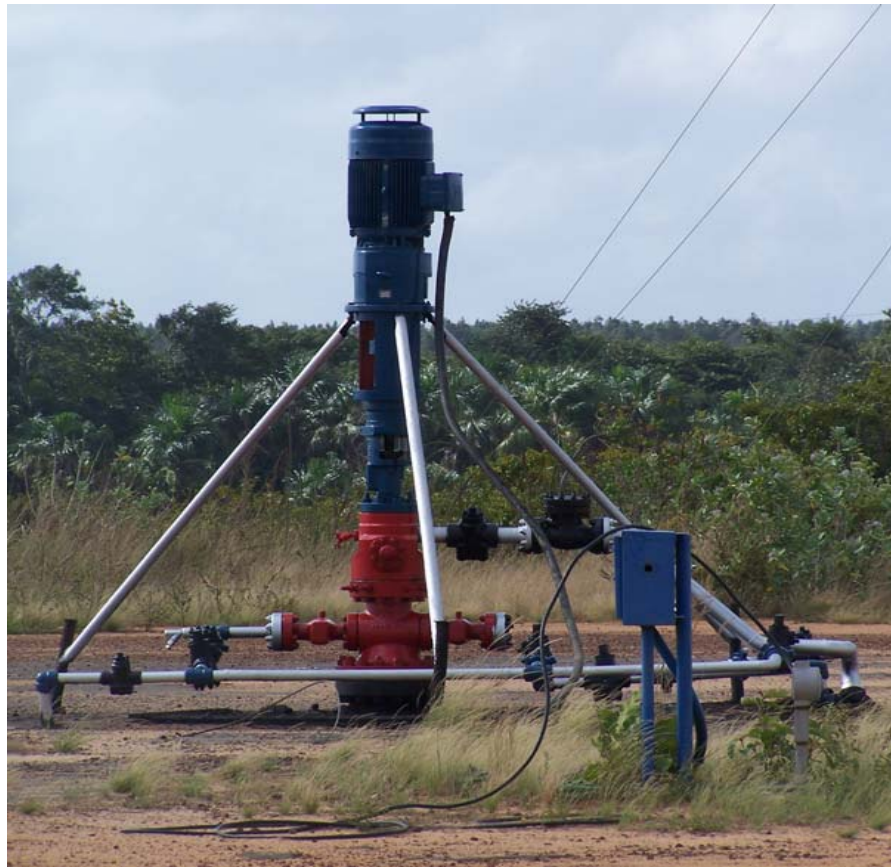
Figura 2.4. Bomba de cavidad progresiva (BCP) de un solo motor.
