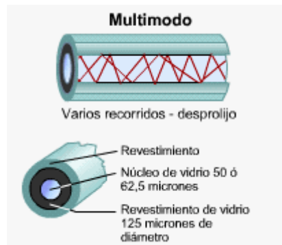
Figura 2.5. Corte transversal de Fibra Multimodo[1]
