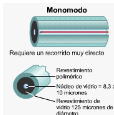
Figura 2.4. Corte transversal de Fibra Monomodo.[1]
