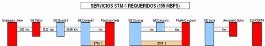
Figura 5.10 Agregado en nodos de STM-1's [Fuente propia]
