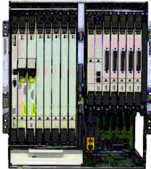
Fig 2.8 Parte física DSLAM 7301 alcatel [2]
