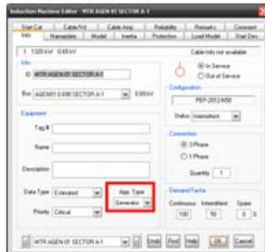
Figura 5.3. Aplicación de la máquina de inducción como generador
