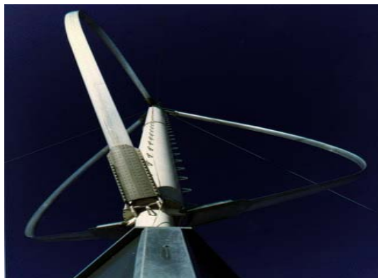
Figura 2.13. Aerogenerador tipo Darrieus. [3]
