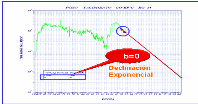
Figura 4.1. Cotejo Gráfico de Producción yacimiento COEFG RG 14 con la Herramienta OFM para estimar el tipo de declinación
