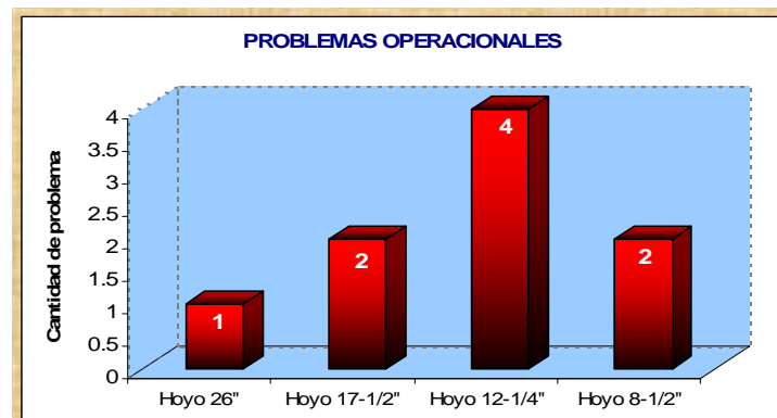
Figura N° 4.12: Cantidad de Problemas Operacionales por Hoyo (RG-283).
