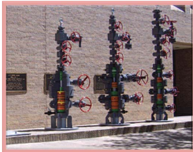
Figura 2.8 Cabezales de Pozo [13]
