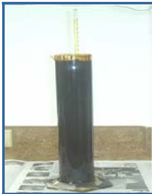
Figura 3.3 Método del hidrómetro. Fuente: Laboratorio FSO Nabarima.
