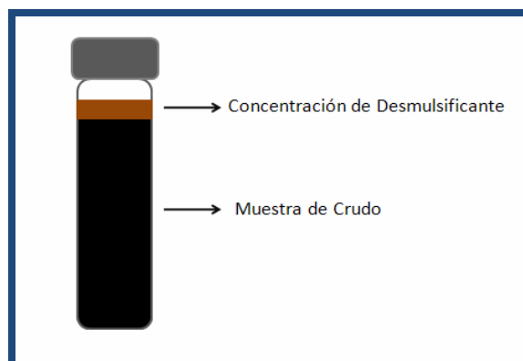
Figura 3.6 Dosificación de las sustancias para preparar los sistemas SOW. [Fuente propia]
