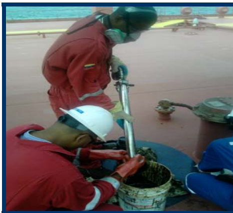
Figura 3.2 Toma de Muestra del Crudo Almacenado. Fuente: FSO Nabarima
