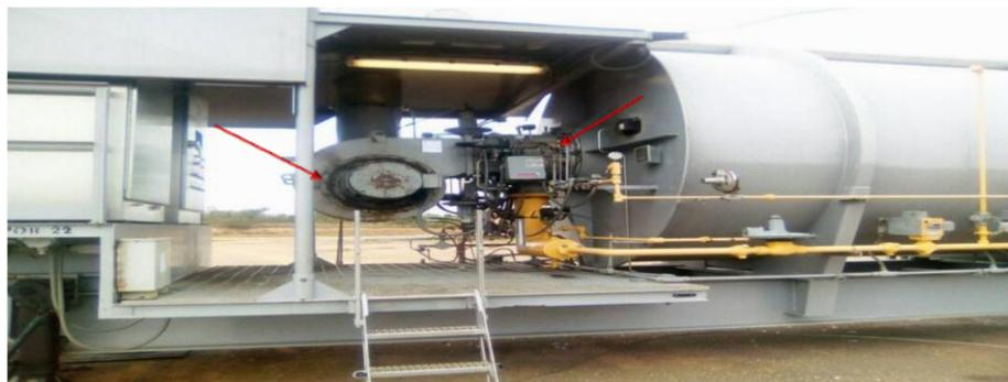
**Figura 4.3 Quemador Acoplado a Zona de Radiación**
