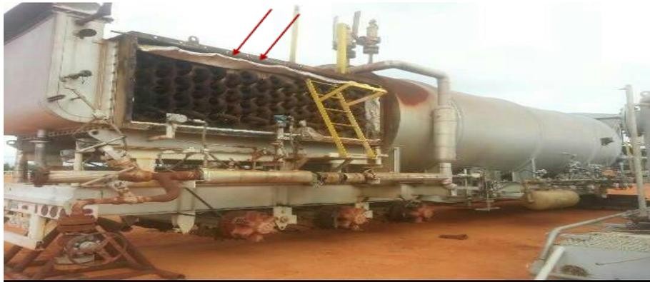
**Figura 4.4 Sección de Convección o Chimenea**
