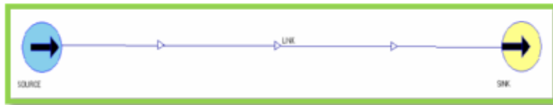
Figura 3.12 Representación de un tramo de tubería.
