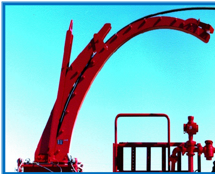
Figura N° 3.16 Guía de la Tubería o Cuello Ganso. [6]
