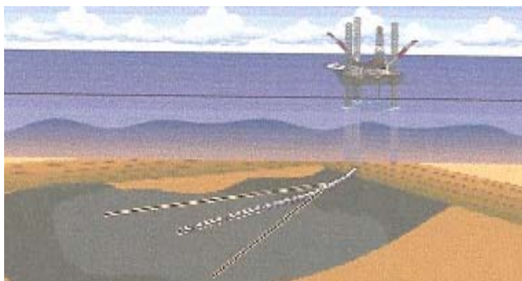
Figura N° 3.6 Perforación Múltiple a partir de una sola Estructura. [5]
