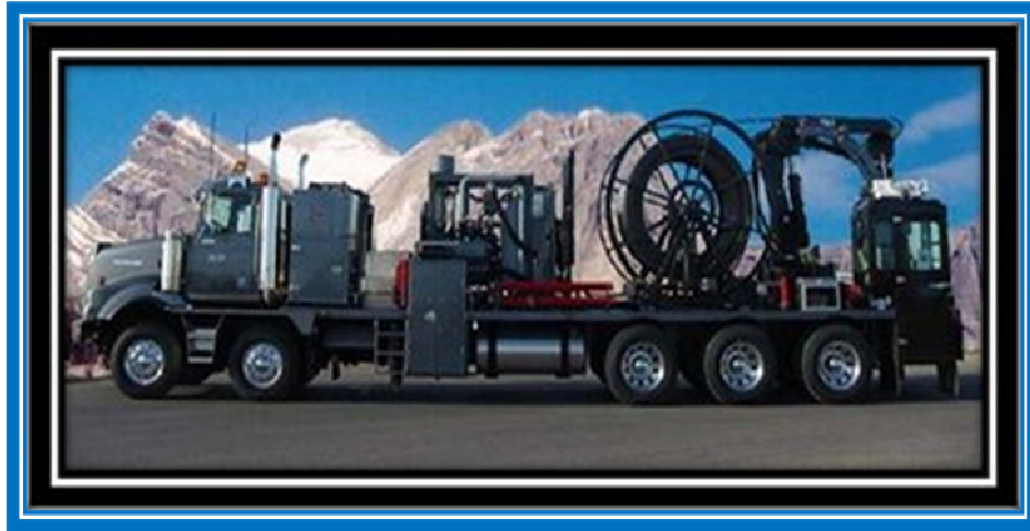
Figura N° 3.12 Unidad de Transporte para el Carrete de Almacenamiento, usado para Enrollar y Desenrollar la Tubería Coiled Tubing. [6]
