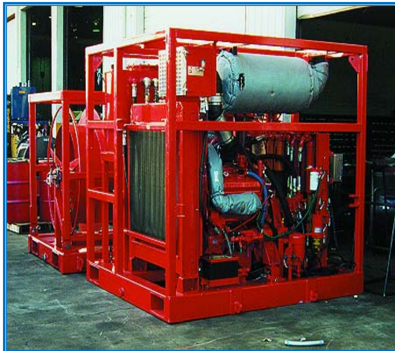
Figura N° 3.18 Unidad de Potencia Hidráulica. [7]
