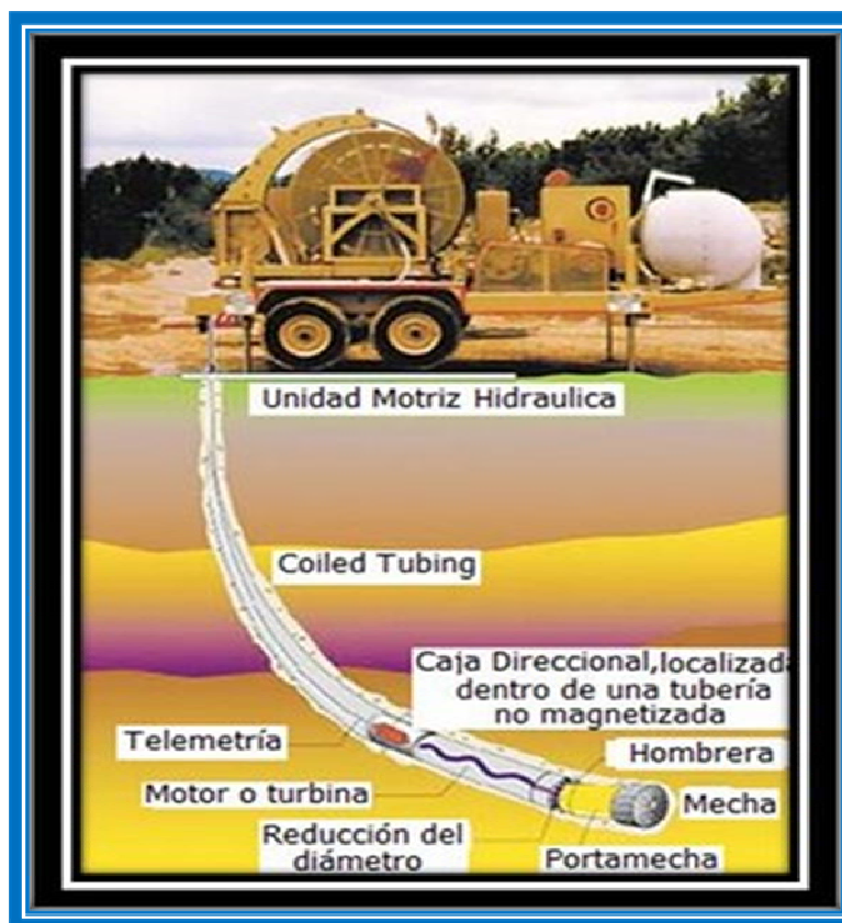
Figura N° 3.14. Diagrama que muestra Diferentes Componentes de la Tubería CT, tales como la Unidad Motriz Hidráulica, la Turbina y la Caja Direccional. [7]
