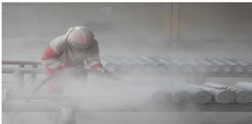
**Figura 4.1. Proceso de Sandblasting**
