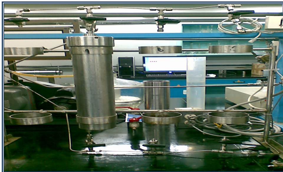
Fig. N° 4.24 Acumuladores de fluidos
