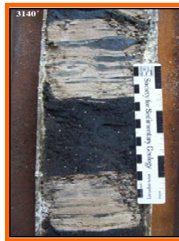
Figura N° 2.31. Arena de grano grueso saturada de crudo, miembro Morichal Medio, núcleo del pozo xx 9s1. [2]
