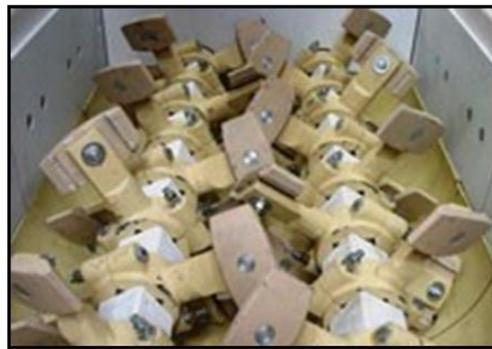
**Figura 4.23 Sistema de paletas mezcladoras**
