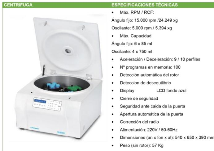
**Figura 4.51 Especificaciones técnicas de centrifuga**
