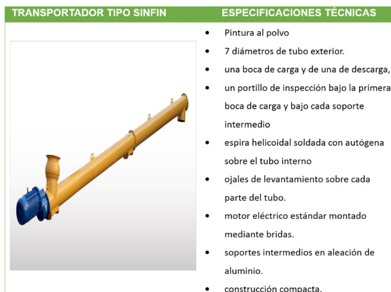
**Figura 4.35 Especificaciones transportador tipo sinfín**
