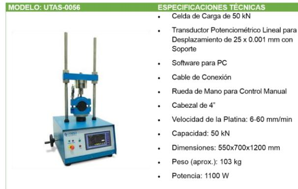
**Figura 4.44 Especificaciones técnicas de máquina de ensayos Marshall**
