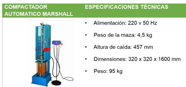
**Figura 4.48 Especificaciones técnicas de Compactador automático Marshall**
