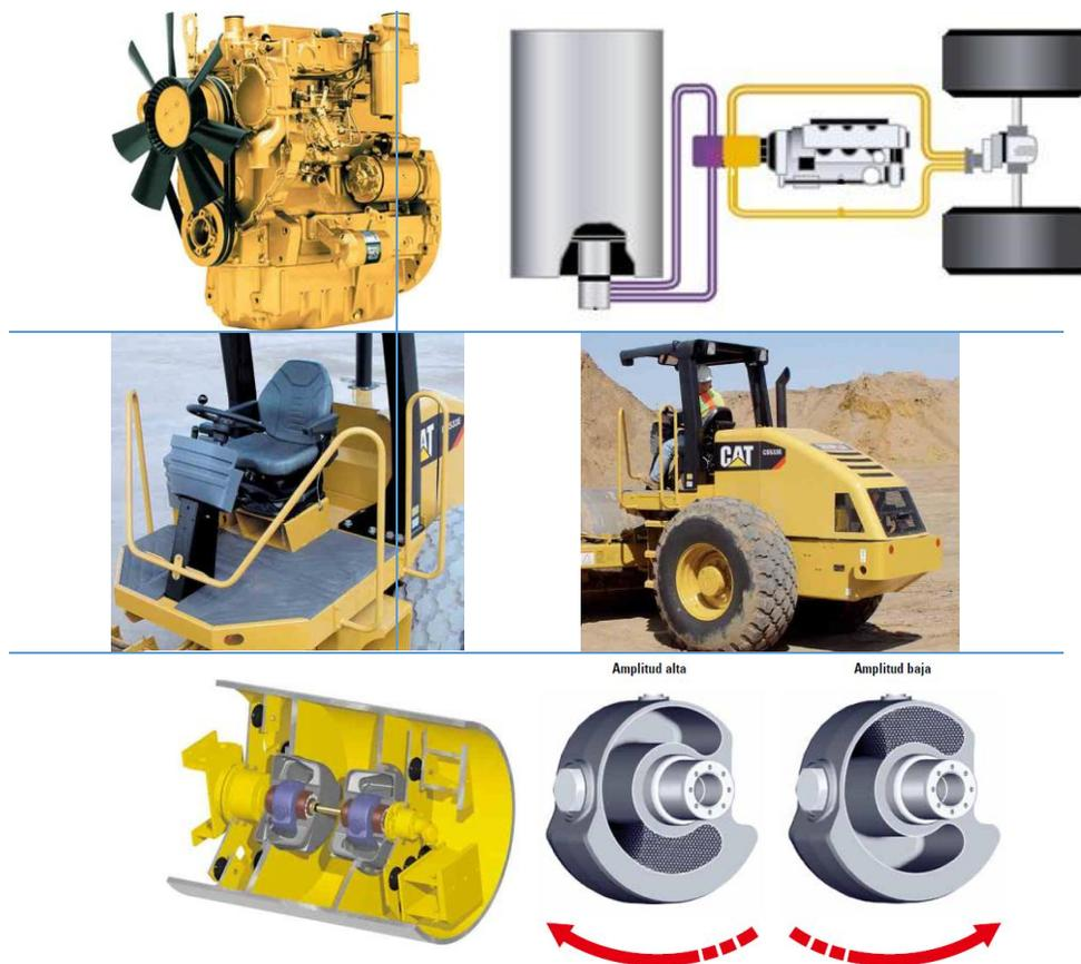
**Figura 2.11. Estructura de un vibrocompactador**
