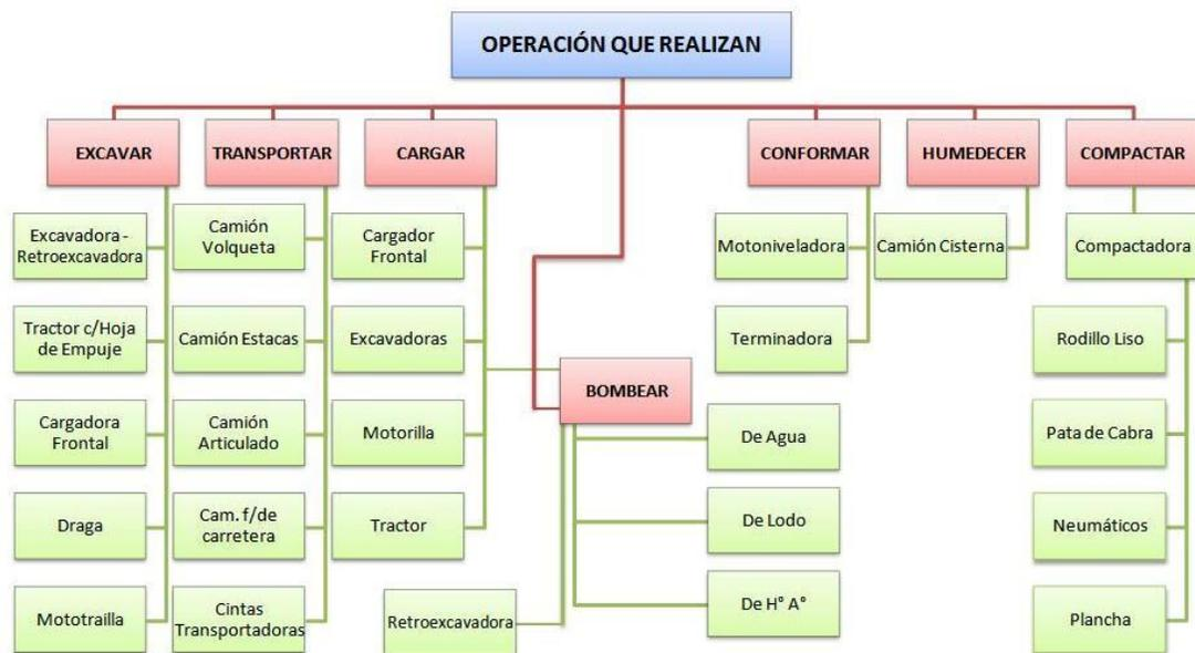
**Figura 2.3. Clasificación de las maquinarias pesadas según las operaciones que realizan**
