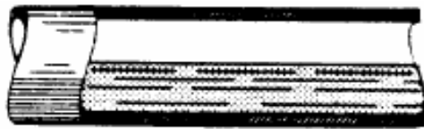
Figura 2.8. Representación gráfica del régimen de flujo estratificado suave [16]
