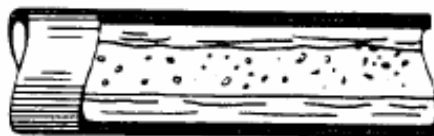
Figura 2.11. Representación gráfica del régimen de flujo tipo anular [18]
