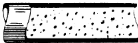
Figura 2.12. Representación gráfica del régimen de flujo tipo disperso [18]
