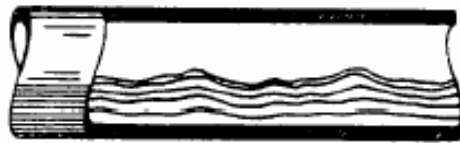
Figura 2.9. Representación gráfica del régimen de flujo estratificado ondulante
