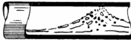
Figura 2.10. Representación gráfica del régimen de flujo tipo tapón [18]
