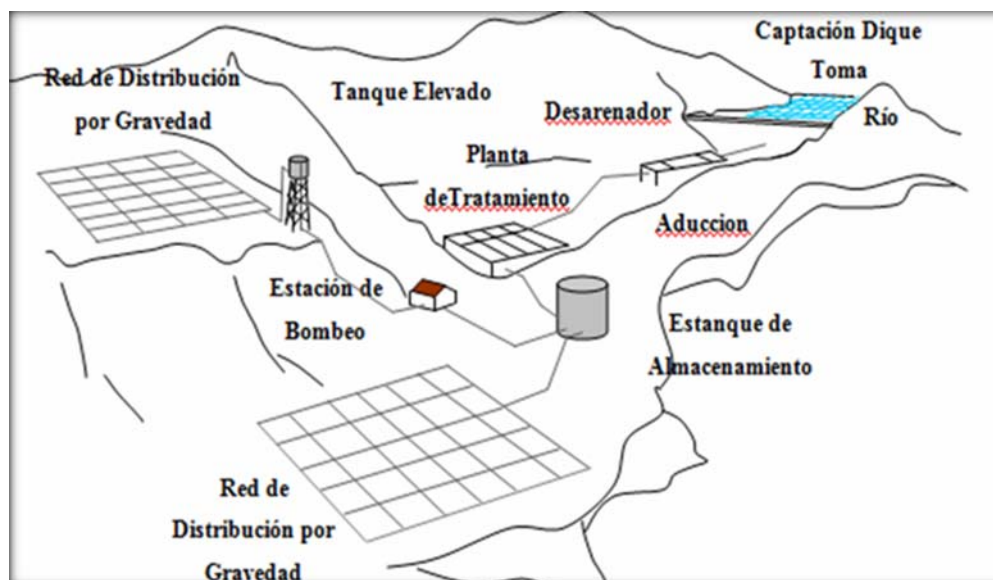
Figura 2.3. Componentes de un Sistema de Abastecimiento.
