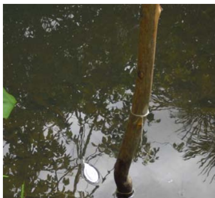
Figura 4.2. Flotador para la Medición de la Velocidad
