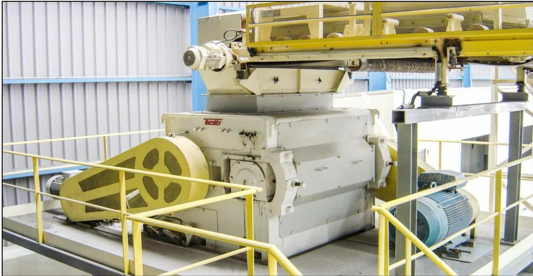
Figura 5.10 Desintegrador 127 C (Metalcertima 2022).
