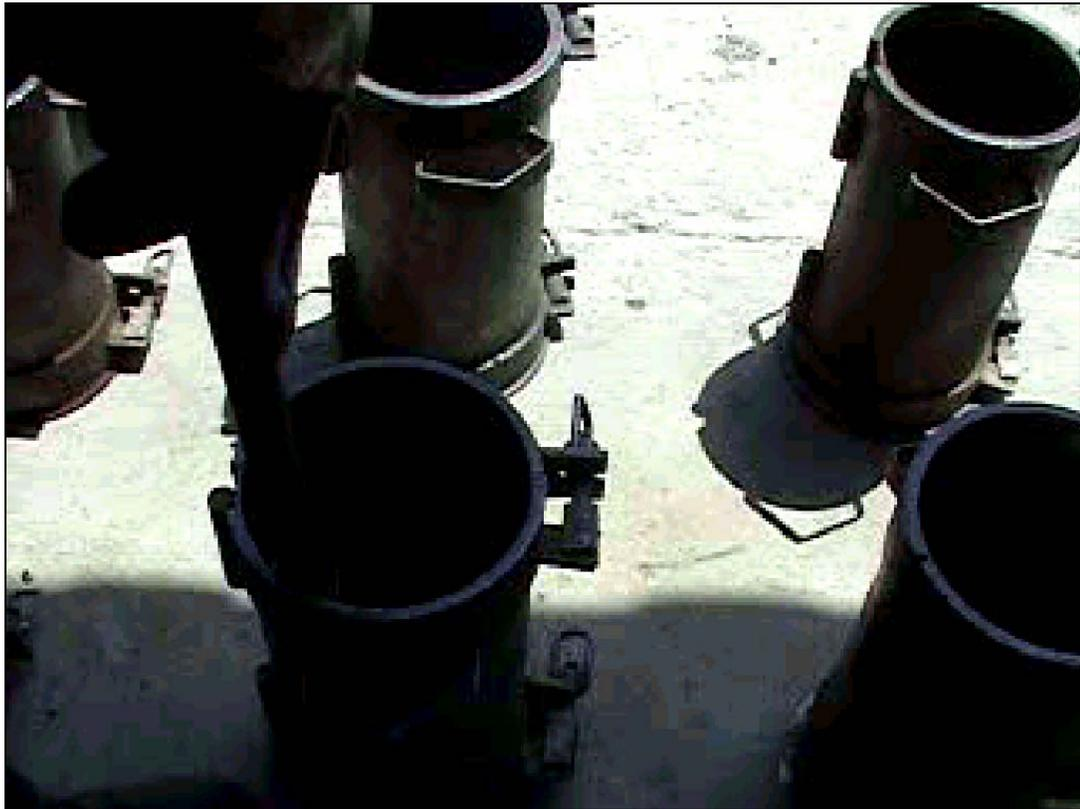
Foto 3.7 Moldes cilíndricos de 15 cms. de diámetro y 30 cms. de altura
