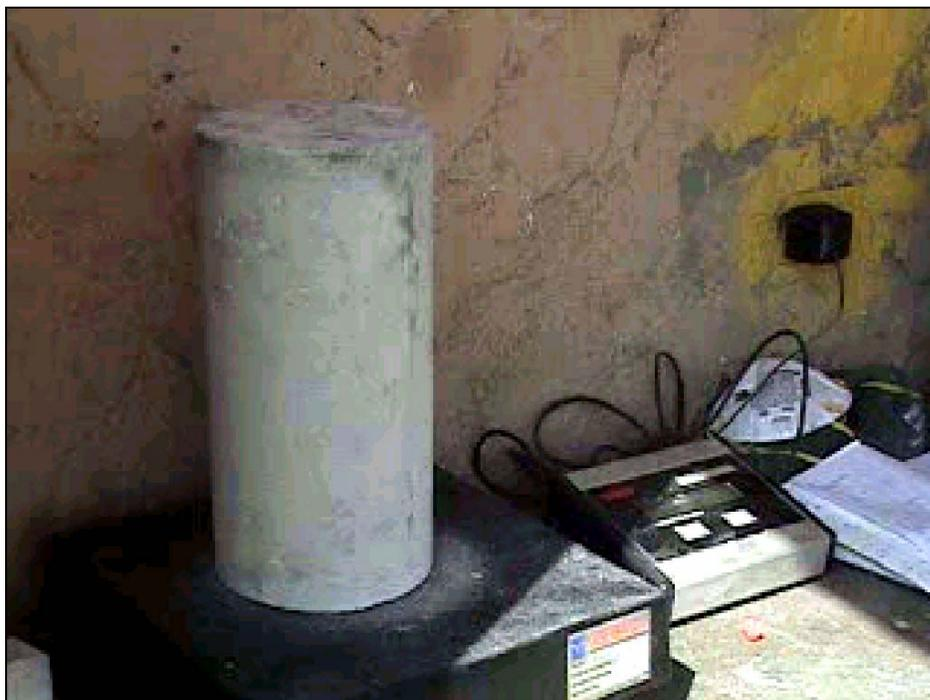
Foto 3.13 Pesada del cilindro seco antes del ensayo a compresión.
