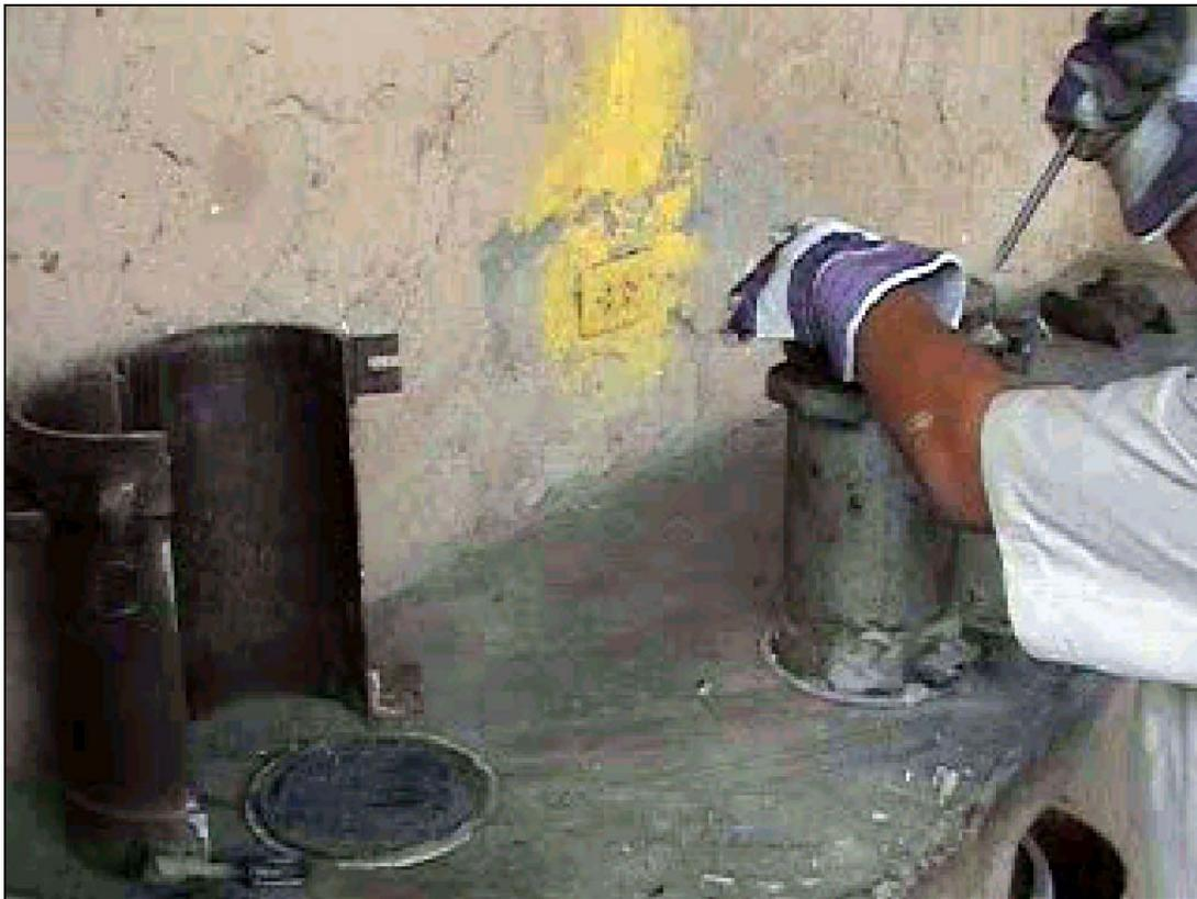
Foto 3.11 Probetas cilíndricas de concreto
