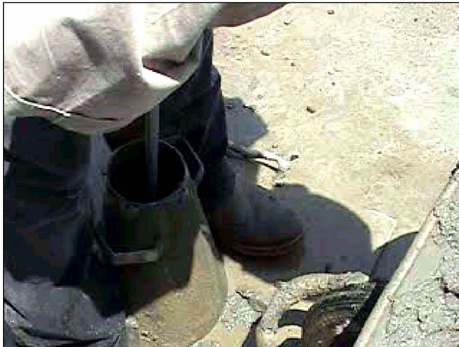
Foto 3.5 Toma del Asentamiento con el cono de Abrahms
