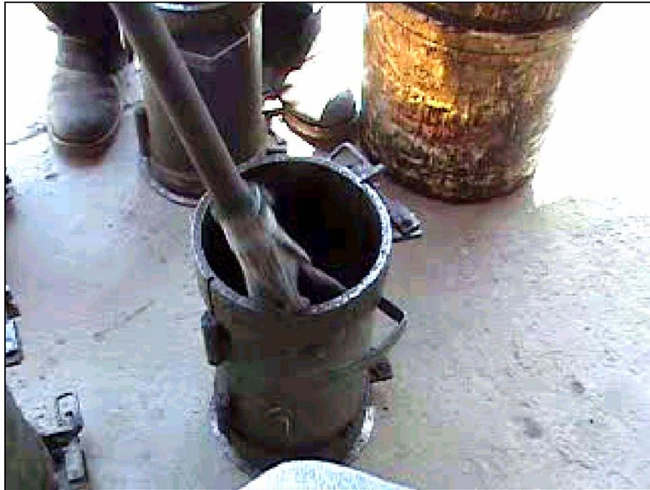
Foto 3.8 Lubricación de los moldes
