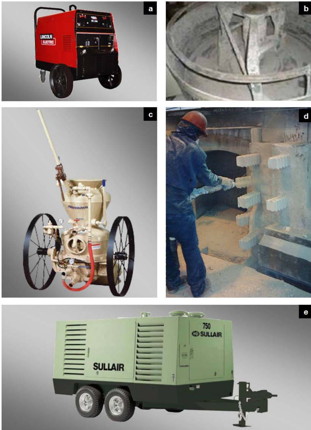
Figura 3.8. Ejemplos de equipos utilizados en el revestimiento por proyección: a) maquina de soldar Lincoln R3R-300; b) mezcladora intensiva; c) equipo de proyección; d) operador de la boquilla del equipo de proyección instalando el material, e) compresor portátil de 750 cfm.
