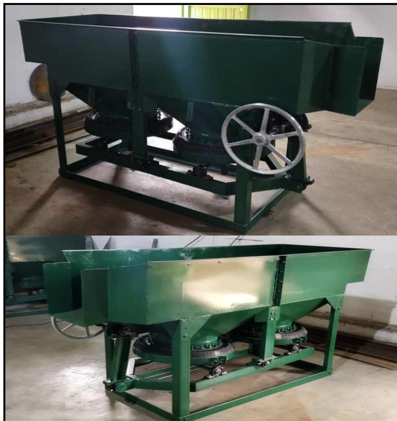
Figura 4.12 Jig, separador de material.
