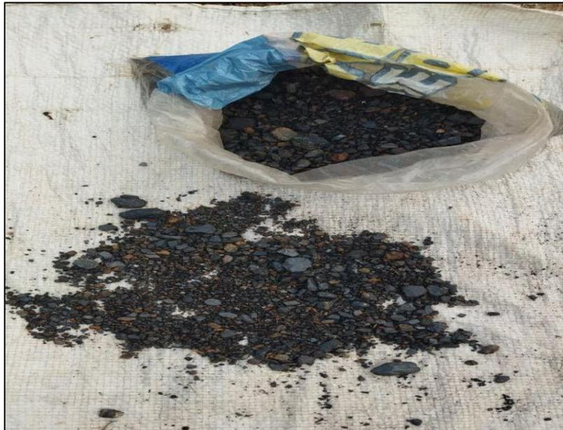
Figura 5.9 Selección del material para el análisis macroscópico y separación para la aplicación del ácido muriático.
