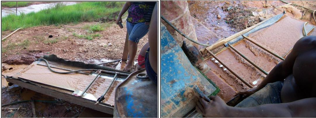
Figura 2.8 Proceso de amalgamación con plancha.
