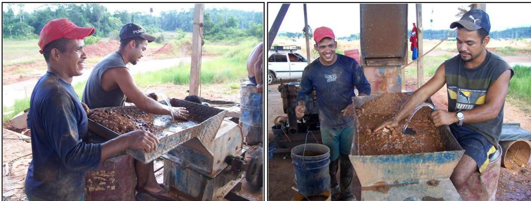
Figura 2.7 Proceso de molienda con molino de martillo.
