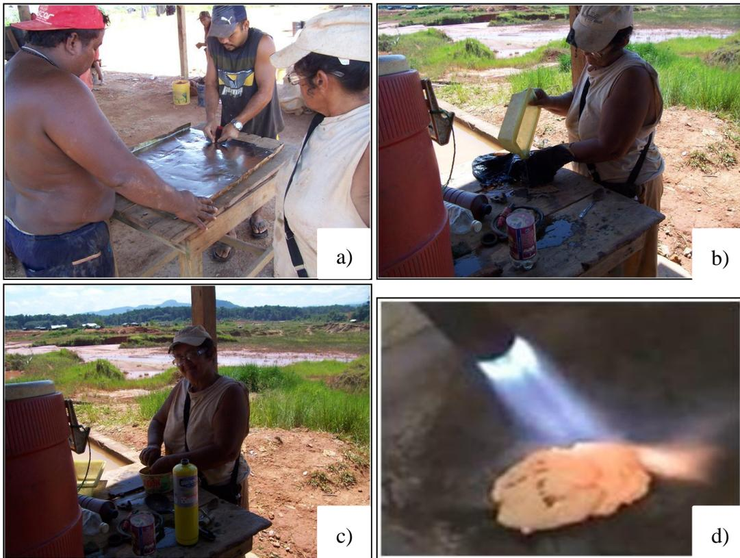
Figura 2.9 Proceso de recuperación del oro. a) remoción de la amalgama b y c) lavado y filtrado de la amalgama, d) obtención del oro por calentamiento de la amalgama.
