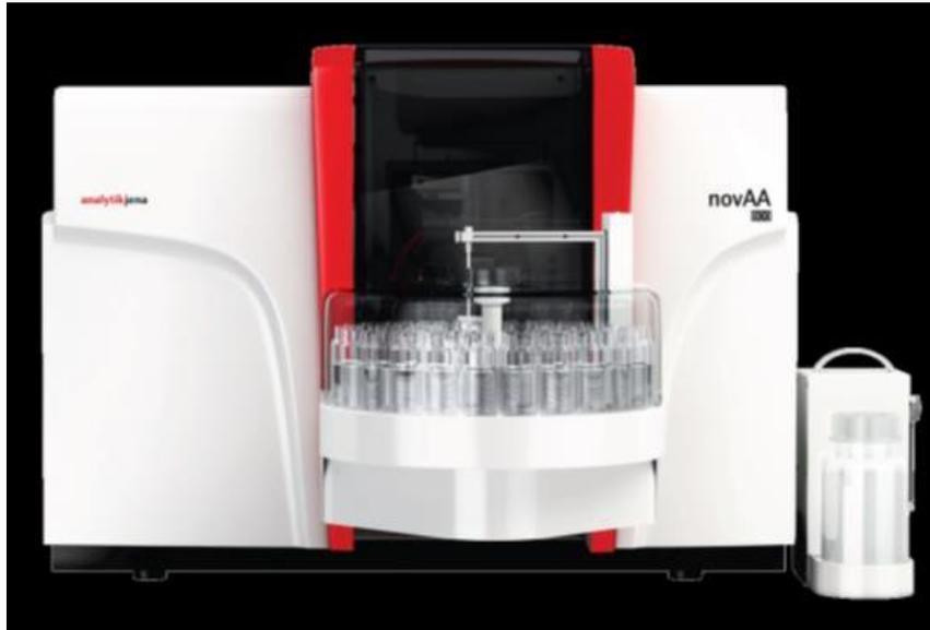
Figura 3.1. Equipo de Espectrometría de Absorción de llama (ASS) novAA-800.
