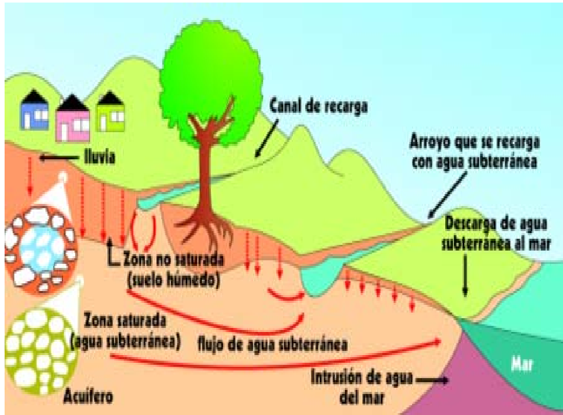
Fig. # 3. Flujo del Agua Subterránea.
