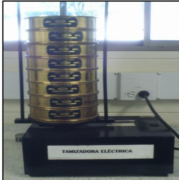
Figura 3.4 Baterias de tamices para análisis granulométrico de suelos.
