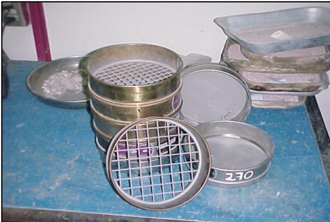
Figura 3.3 Tamices para análisis granulométrico.
