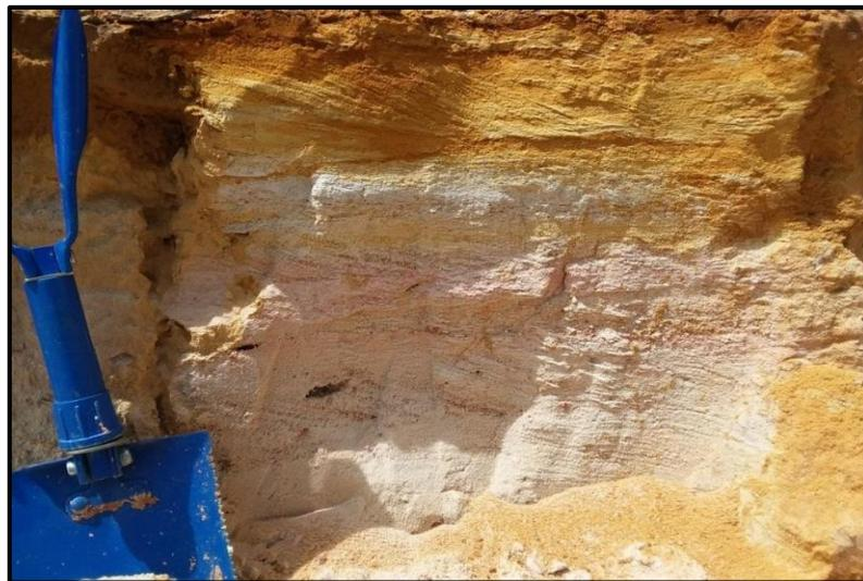
Figura 5.3 Calicata exploratoria donde se observa horizontes lateríticos areno-arcillosos de color rojizo-amarillento
