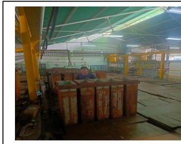
**Figura 4.3** tanque 1 congelación de paneles
