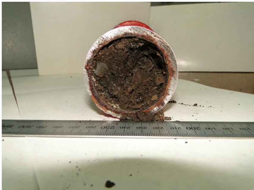
**Figura 4.33.** Corte transversal de la muestra de tubería.
