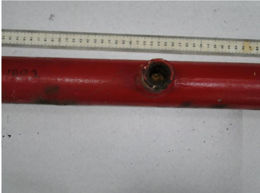
**Figura 4.32.** Sección de muestra n°1. Zona de empalme con el rociador.
