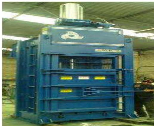
**Figura 2.3. Máquina compactadora [6].**
