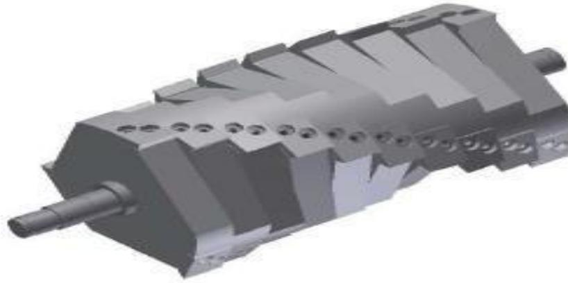
**Figura 4.10. Eje con cuchillas desfasadas [4].**
