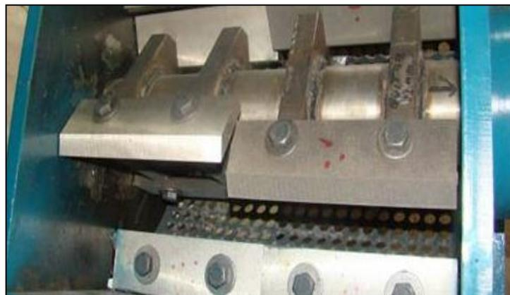
**Figura 4.7. Cuchillas de corte oblicuo [2].**
