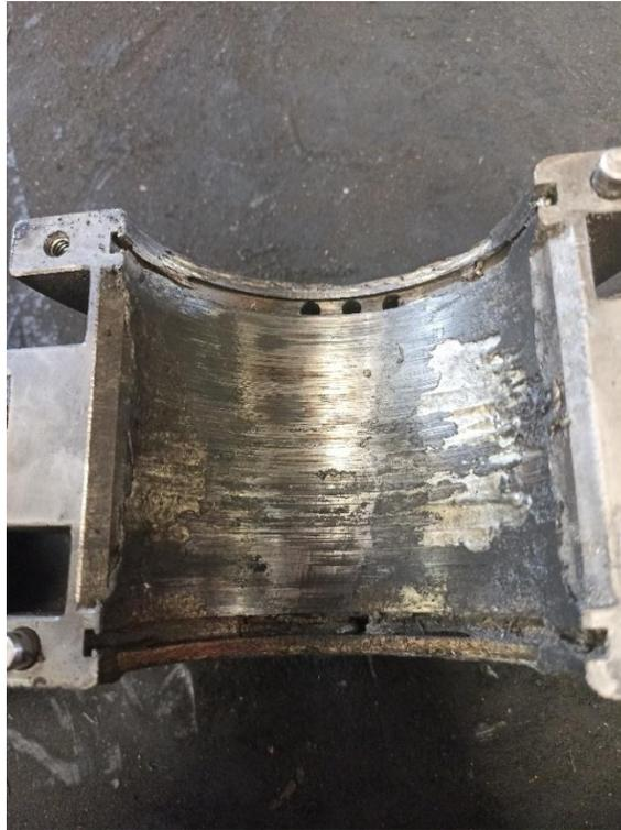
**Figura 4.18. Desgaste en los cojinetes deslizantes. Fuente: Propia**
