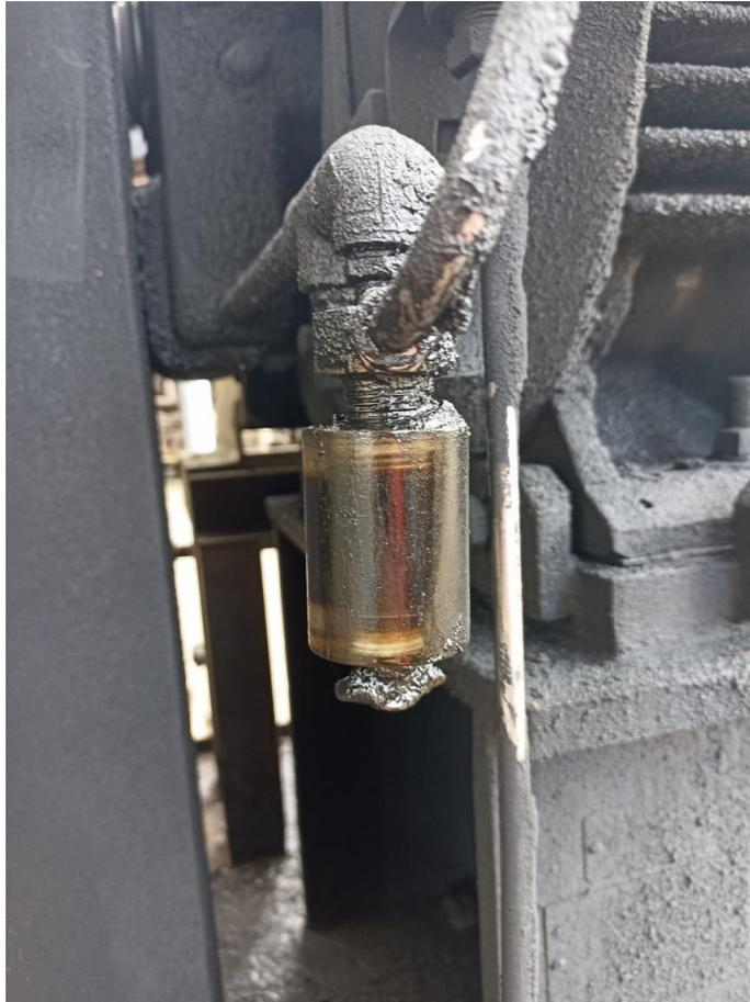
**Figura 4.29. Coloración turbia del lubricante. Fuente: Propia**
