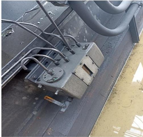
**Figura 4.26. Ángulos indebidos en las tuberías de lubricación.**
