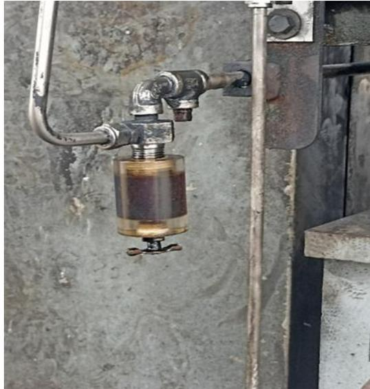
**Figura 4.25. Presencia de partículas en el lubricante. Fuente: Propia**
