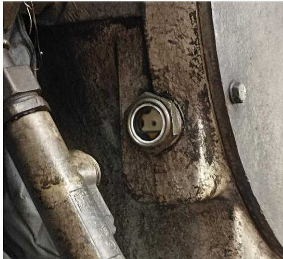
**Figura 4.22. Nivel de lubricante inadecuado. Fuente: Propia**
